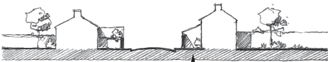
Parties de construction en limite de voie reliée par des murs de clôture.
